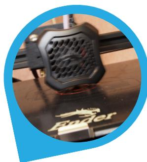
**Buse:** permet au filament chauffé d'imprimer
